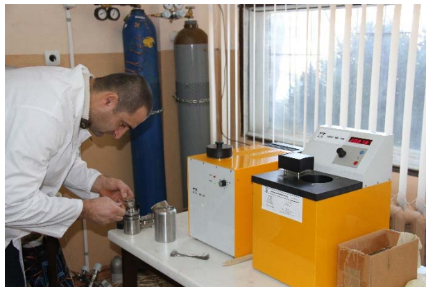
Figura 1. Aspecte din timpul măsurării puterii calorifice a probelor de biomasă la calorimetrul LAGET MS -10A.
