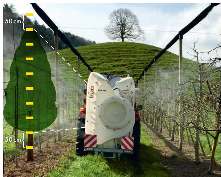
Хорошо отрегулированный опрыскиватель обеспечивает равномерное покрытие всей кроны дерева, от верхушки до низких побегов, внутри дерева, а также на верхней и нижней части листьев.
