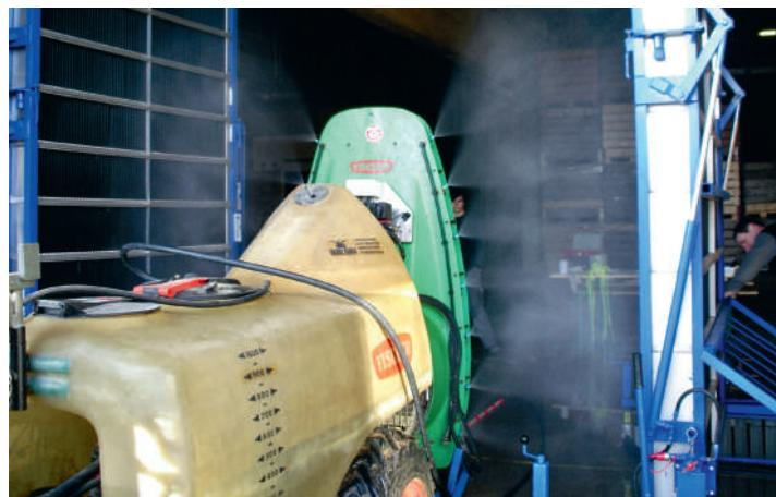
Обязательное тестирование опрыскивателя, проводимое каждые четыре года, обеспечивает оптимальную настройку оборудования и создает важную предпосылку для успешного применения препаратов.
