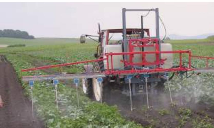
Furtunurile de pulverizare verticale „drop-legs” distribuie lichidul pe partea inferioară a frunzelor, unde preferă să se ascundă unii dăunători, de exemplu afidele.
